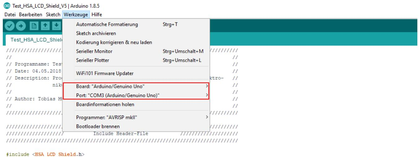
Im Anschluss können Sie das Beispielprogramm auf Ihrem Arduino hochladen. Befolgen Sie die Anweisungen auf dem Display, um die LCD-Shield Funktionen zu testen.
